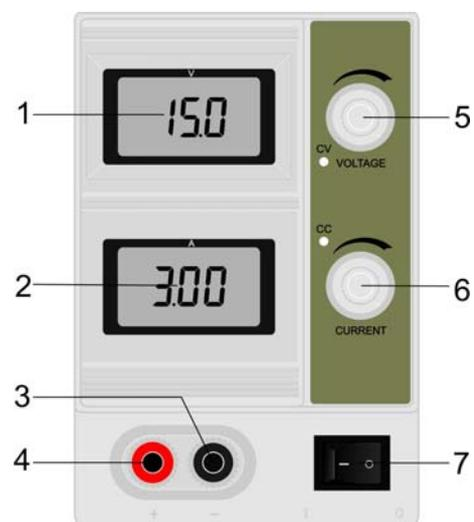
Устройство имеет дисплей выхода. Дисплей имеет 2 показания: тока и напряжения. На выходе 0-15 Вольтов с 0-3 Амперами. Стандартное напряжение на входе только 230В АС и защита с помощью предохранителя.
